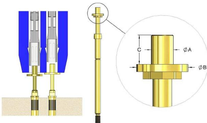
Щупы с изолирующими колпачками используются, когда тестируется длина контакта, выступающего из разъёма. Принцип тестирования основан на том, что контактная поверхность внутри изолирующего колпачка контактирует с тестируемым элементом
