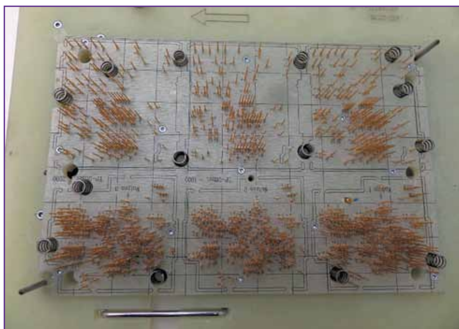
Рис. 7. Пластина с установленными тестовыми щупами
