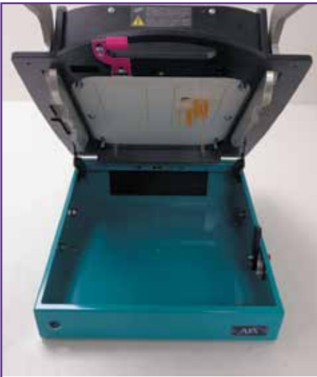
Рис. 8. ММІ-В. Нижняя часть корпуса тестовой установки
