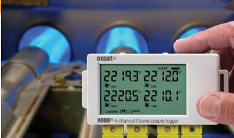
Регистратор для термопар НОВО UX120 - 4-канальный регистратор с ЖК дисплеем для измерения и записи температуры. Регистратор записывает температуру в широком диапазоне (от -260 до 1820°C) и предназначен для подключения термопар J, K, T, E, R, S, B и N.
