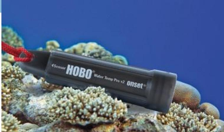
Регистратор HOBO Water Temp Pro v2 обладает 12-битным разрешением и снабжён датчиком, обеспечивающим точность  $\pm 0.2^{\circ}\text{C}$  в широком диапазоне температур. Устройство помещено в прочный обтекаемый корпус для применения в пресной и солёной воде, оборудовано оптическим USB интерфейсом для выгрузки данных "в полях", даже когда регистратор влажный.
