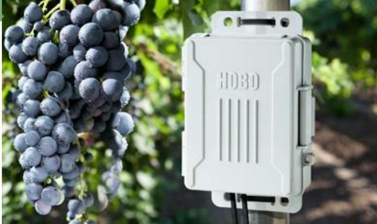
Прочная и компактная метеостанция HOBO USB Micro Station представляет собой регистратор данных для многоканального мониторинга микроклимата. Метеостанция питается от батареек и рассчитана на подключение пяти датчиков типа Smart, оборудована дверцей на петлях, что упрощает установку датчиков. Микрометеостанция оборудована встроенным USB портом для быстрой выгрузки данных на компьютер и монтажными петлями для упрощения установки.
