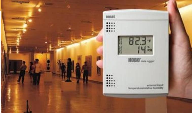
Регистраторы НОВО U14 отображают и записывают температуру и относительную влажность и подают сигналы тревоги. Уведомления о тревожных событиях можно получить, используя дополнительный Автоматический номеронабиратель или дистанционный звуковой сигнализатор. регистраторы предназначены для использования на производстве и хранении, когда наблюдение и документирование температуры и относительной влажности является критичным.
