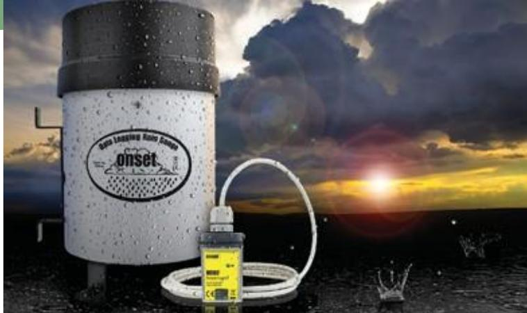
Осадкомер HOBO RG3 - автономное устройство, состоящее из регистратора данных и датчика с опрокидывающимся ковшом. Встроенный регистратор оборудован датчиком температуры и подключается к датчику через кабель, так что его можно поместить в солнцезащитный экран.
