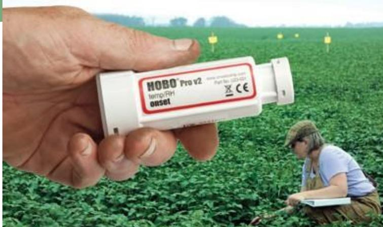
Регистраторы HOBO Pro v2 обеспечивают высокую точность измерения температуры и относительной влажности в широком диапазоне.
