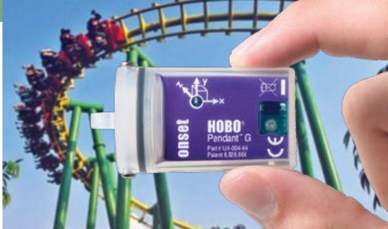
Измеряйте движение в трёх направлениях при помощи регистратора HOBO Pendant G. Можно измерить ускорение и угловое смещение по одной, двум или трём осям. Используйте эти данные для наблюдения за действиями и усовершенствования работы.
