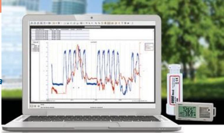
ПО NOBOWare предназначено для настройки, построения графиков и анализа данных регистраторов НОВО. Оно позволяет просматривать данные, строить графики и анализировать данные. ПО быстро устанавливается, быстро считывает данные и отображает графики и экспортирует данные для дальнейшего анализа.
